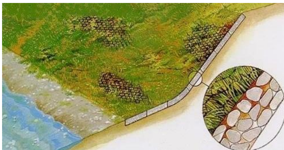
图 2-7 雷诺护垫护坡结构示意图
