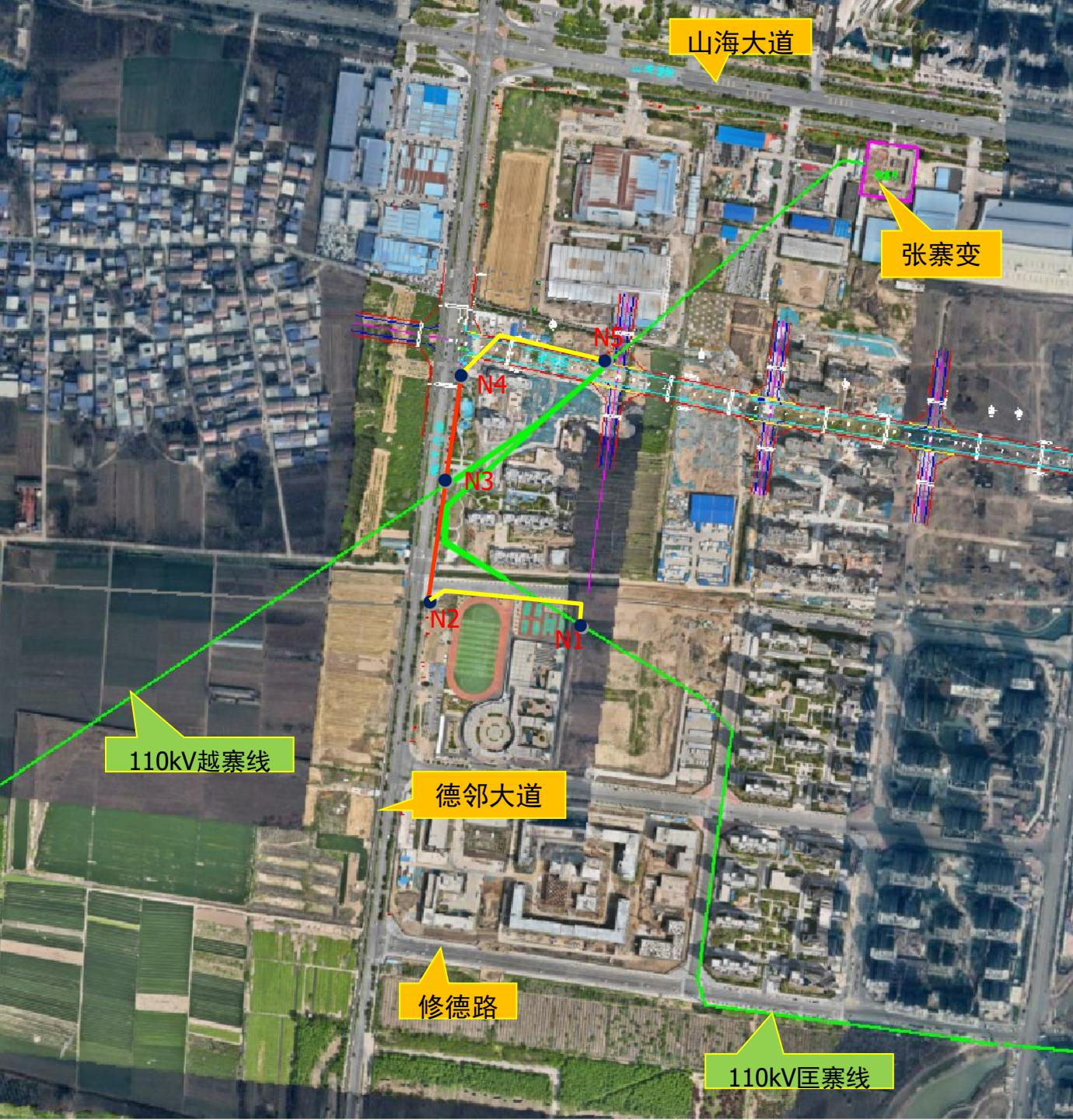
迁改线路范围为太极云墅住宅小区范围内110KV越寨线及匡寨线。新建线路共分为3段，新建架空线路沿德邻大道中向东21.5m城市绿地范围内，线路中心距太极云墅用地红线为28.5m，总长约0.3km，造价约120万元。新建电缆敷设线路共2段：崇德路路中向北15m市政道路内，总长约0.22km，造价约440万元；规划二路路中向南10m市政道路内，总长约0.20km，造价约340万元。以上3段线路改造共计投入约900万元，若沿德邻大道架空线路改为电缆敷设，需额外增加费用约400万左右。以上线路改造由太极置业垫付。
